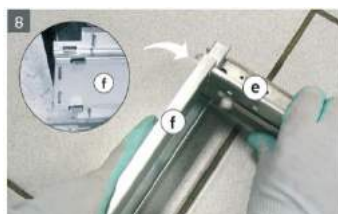
Фаза 8. Вставить в отверстия вертикальной стойки [f] «усы» траверсы с рельсом [e].
