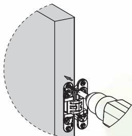
\*Поместить петли в соответствующие пазы в двери (рис.1) и зафиксировать предназначенными шурупами. **ВНИМАНИЕ! Отверстие для крепежа самоцентрирующееся.** Слегка надавить при завинчивании.
