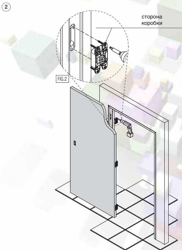
\*Установить дверь на дверной коробке, поместив петли в соответствующие пазы (рис.2). Зафиксировать петли предназначенными шурупами. Петля позволяет максимальное открывание на 160°, необходим ограничитель открывания. Отсутствие данного ограничителя может привести к повреждению петли (рис.2.1).
