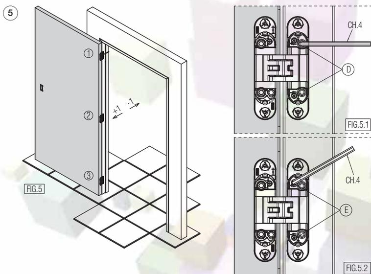
**\*РЕГУЛИРОВКА ПО ГЛУБИНЕ**
